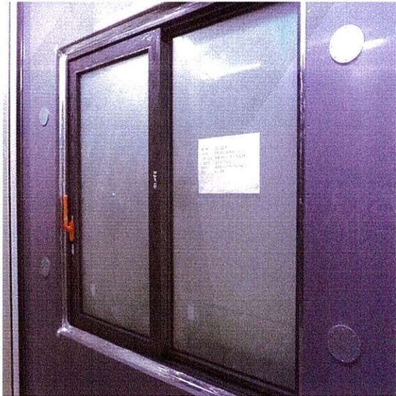
<사진 1> 열관류율 항온측 시험체 모습
